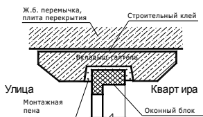
Рис. 2. Деталь установки вкладыш-галтелей
