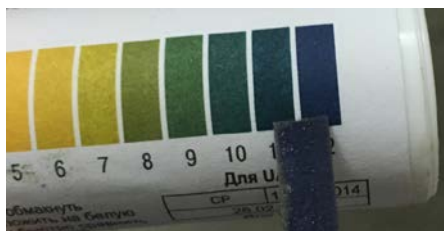
Рис. 1. Проверка pH фибропенобетонной смеси с помощью индикаторной полоски
