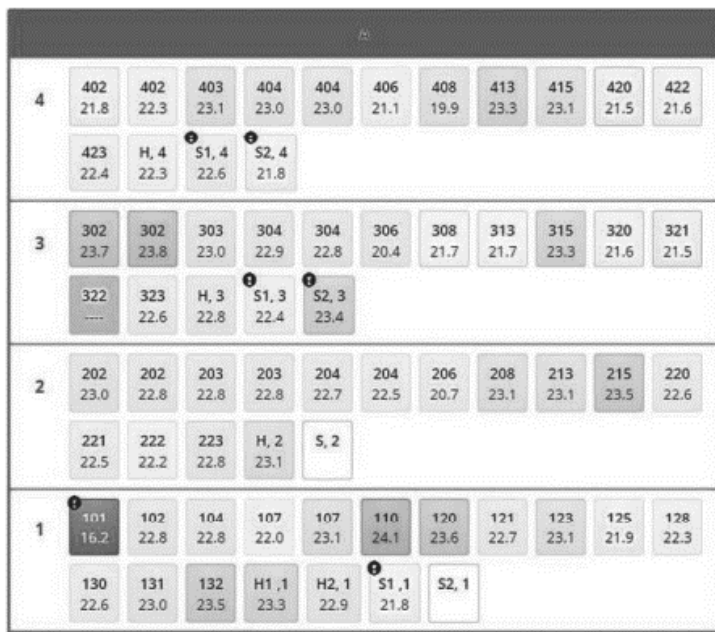
Рис.2. Пример рабочего окна системы LeanHeat с данными о температуре в каждом помещении объекта «Хореографическая школа «Вдохновение», г.Красногорск
