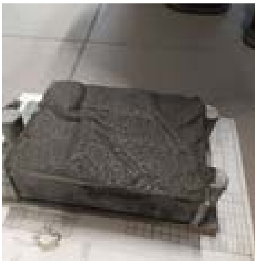
Рис. 4 – Заполненные формочки пенобетонной смесью состава 1
