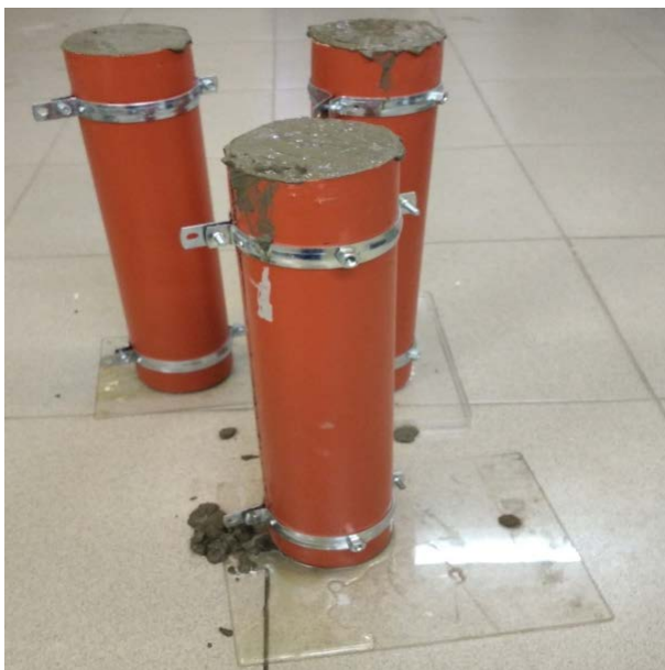
Рис. 1 Заполнение бетонной смеси в специальные формы
