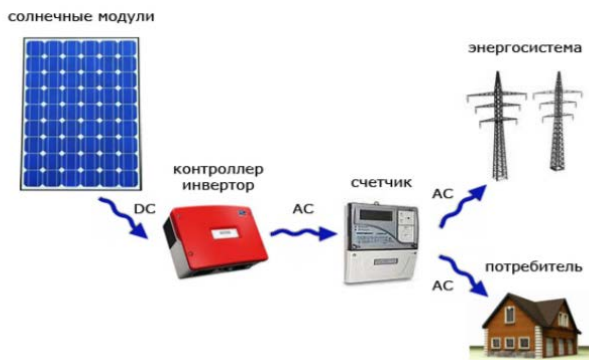
Рис. 3 – Структура солнечной электростанции, соединенной с сетью
