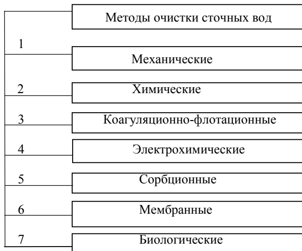
Рис.1. Классификационная схема методов очистки гальванических стоков
