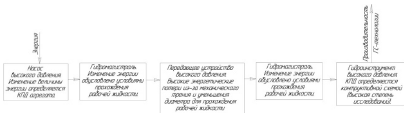
Рис.2. Схема передачи энергии при ГСТ
