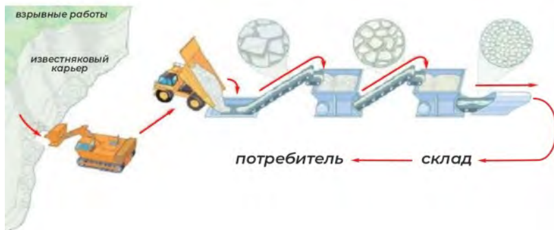
Рис. 1. Технология разработки и этапы дробления известняка
