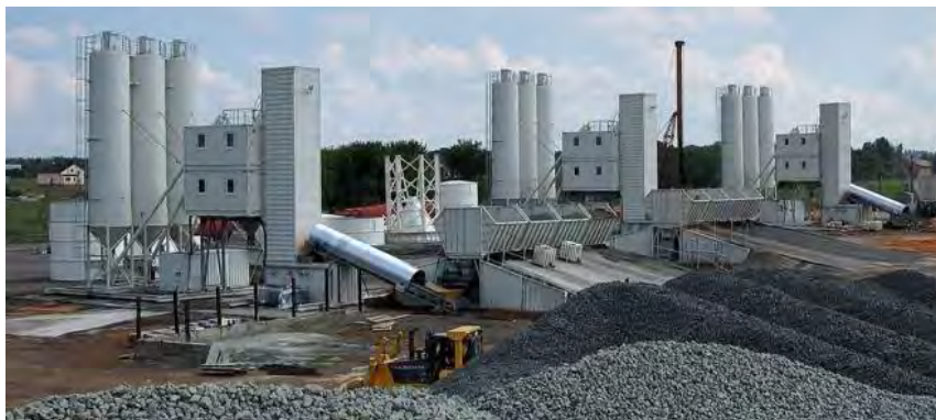
Рис. 2. Площадка подготовки и хранения материалов, вертикальная валковая мельница, центральный сепаратор, промежуточные силоса для гомогенизации и хранения
