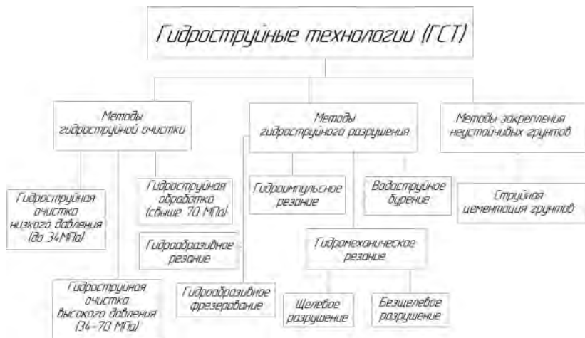
Рис. 1. Классификация методов гидроструйных технологий
