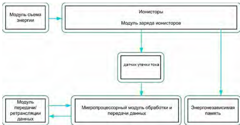
Рис.1. Структура модуля дистанционного мониторинга изоляторов ВЛ, оснащенного датчиком тока
