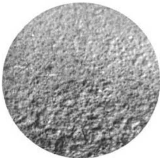
Рис. 3. Топография изношенной металлической поверхности наконечника торфяной шнек-фрезы при ударе по торфяному монолиту
