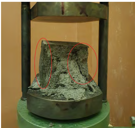
Рис. 2 – пример хрупко-пластичного разрушения
