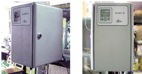
Рис. 5. Стационарная береговая автоматическая станция многокомпонентного контроля качества поверхностных вод
