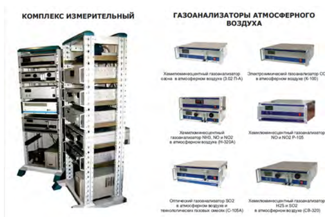
Рис. 4. Составные элементы автоматизированной системы мониторинга загрязнения атмосферного воздуха
