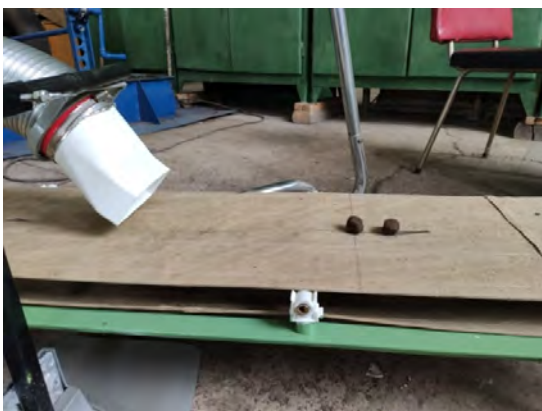
Рис. 1. Эксперимент по всасыванию соплом торфяной крошки
