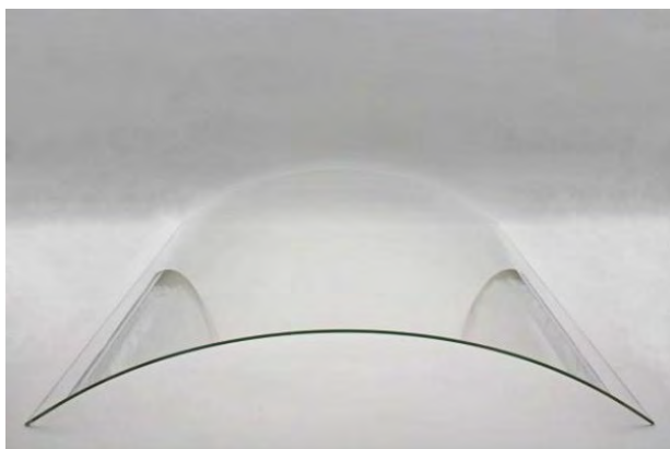
Рис. 1. Тонкое холодное гнутое стекло в процессе ламинирования
