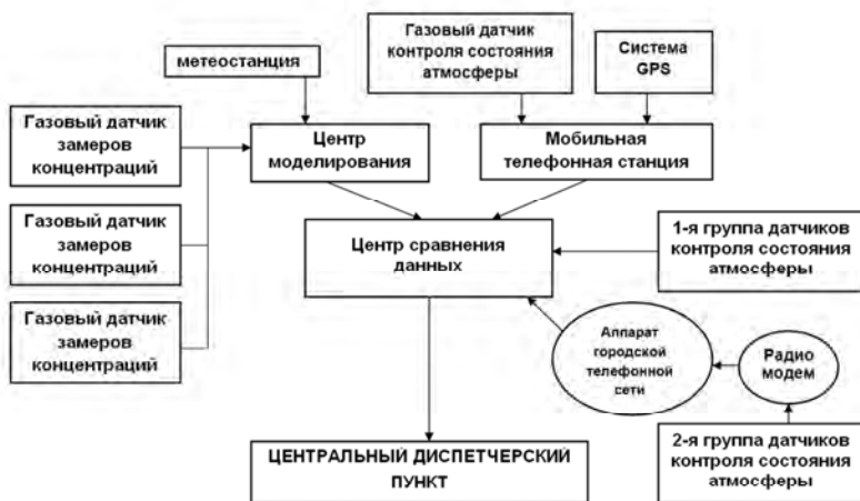
Рис. 2. Функциональная структура автоматизированной системы мониторинга загрязнения атмосферного воздуха
