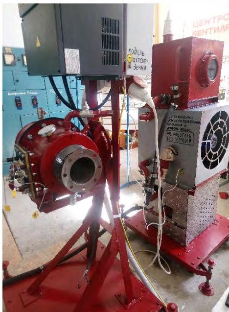
Рис.1. Экспериментальная установка аппарата с вихревым слоем
