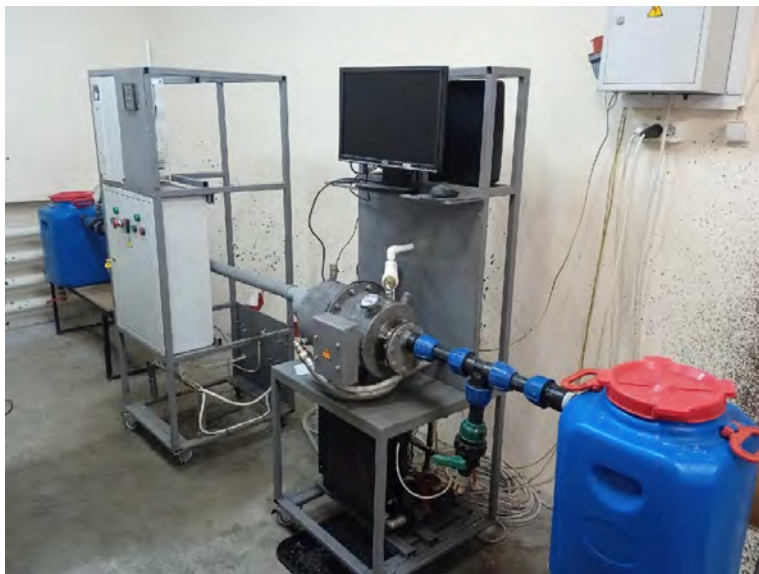
Рис 1. Фото опытной установки по обеззараживанию сточных вод животноводческих комплексов
