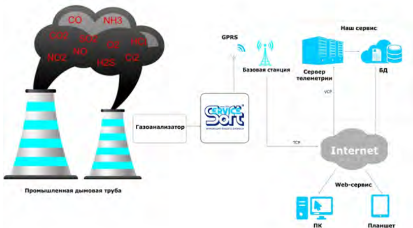
Рис. 3. Схема работы автоматизированной системы мониторинга загрязнения атмосферного воздуха
